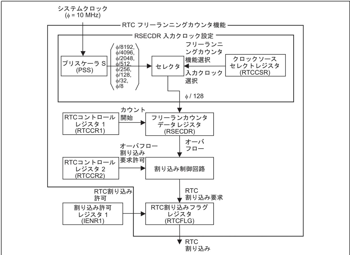
図 1 RTC フリーランニングカウンタ機能のブロック図
