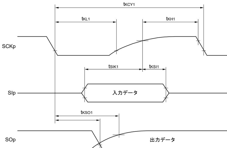
簡易SPI (CSI) モード・シリアル転送タイミング：マスタ・モード(異電位通信時)
