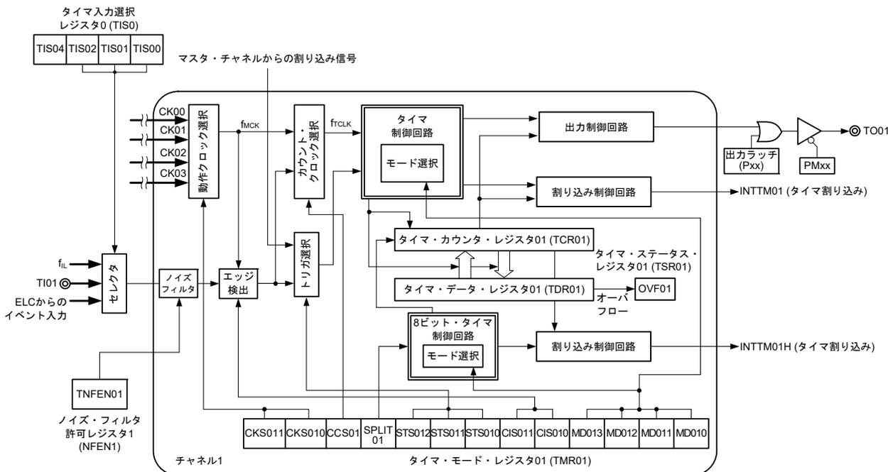
図6-4 タイマ・アレイ・ユニット0のチャンネル2内部ブロック図
