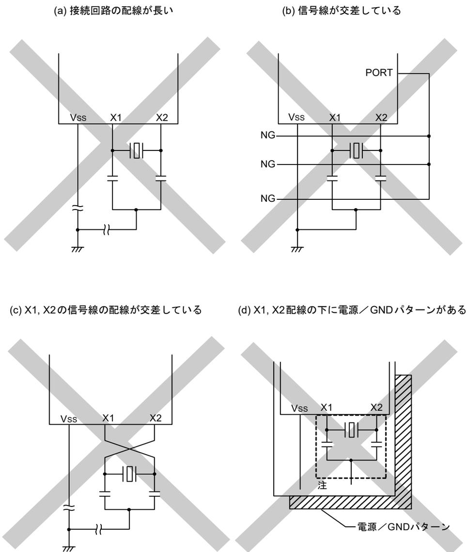
注 多層基板や両面基板において、X1, X2端子と発振子の配線部(図中の点線部分)の下には、電源/GNDパターンを配置しないでください。
