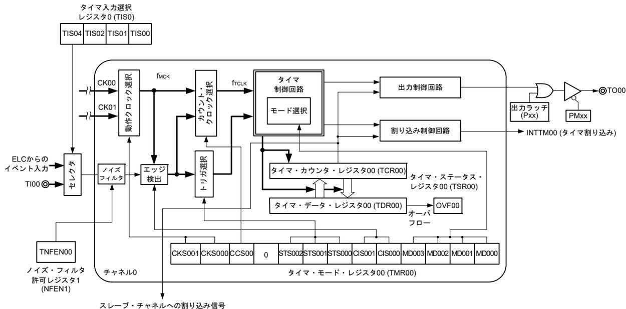
図6-3 タイマ・アレイ・ユニット0のチャンネル1内部ブロック図
