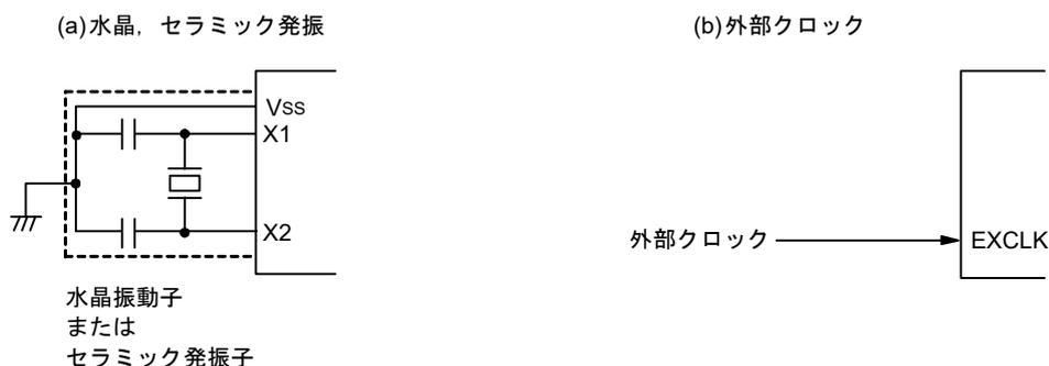
注意 X1発振回路を使用する場合は、配線容量などの影響を避けるために、図5-12の破線の部分を次のように配線してください。
