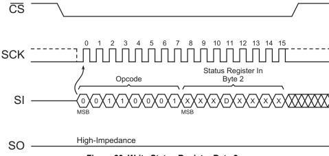
Figure 29. Write Status Register Byte 2
