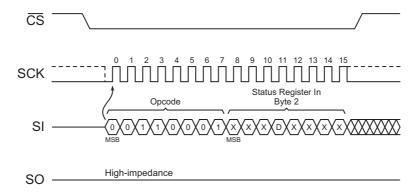
Figure 28. Write Status Register Byte 2
