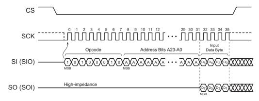
Figure 13. Dual-Input Byte Program
