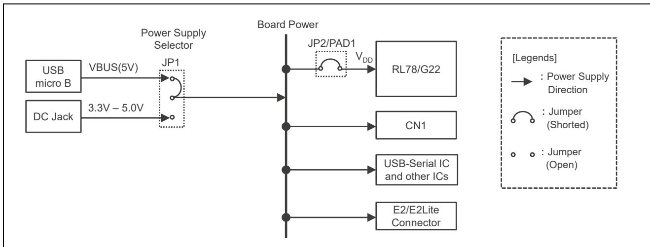
図 2-5 電源系統図
