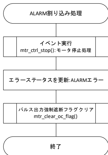
Figure 3-10 フローチャート(ALARM 割り込み処理)
