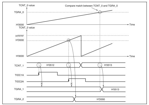
Figure 12.24 Cascaded Operation Example (d)
