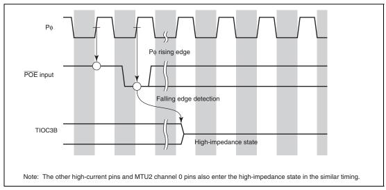
Figure 14.2 Falling Edge Detection
