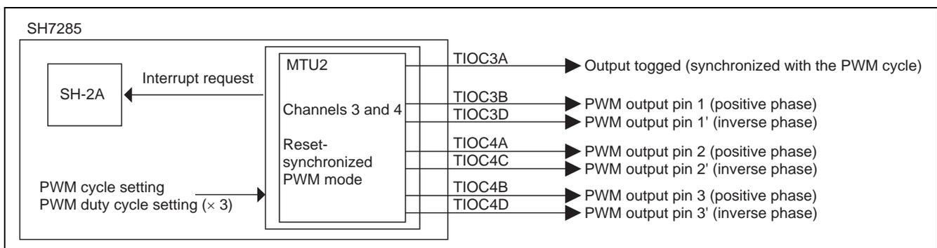
Figure 1 Three-Phase Output of PWM (Reset-Synchronized PWM Mode)
