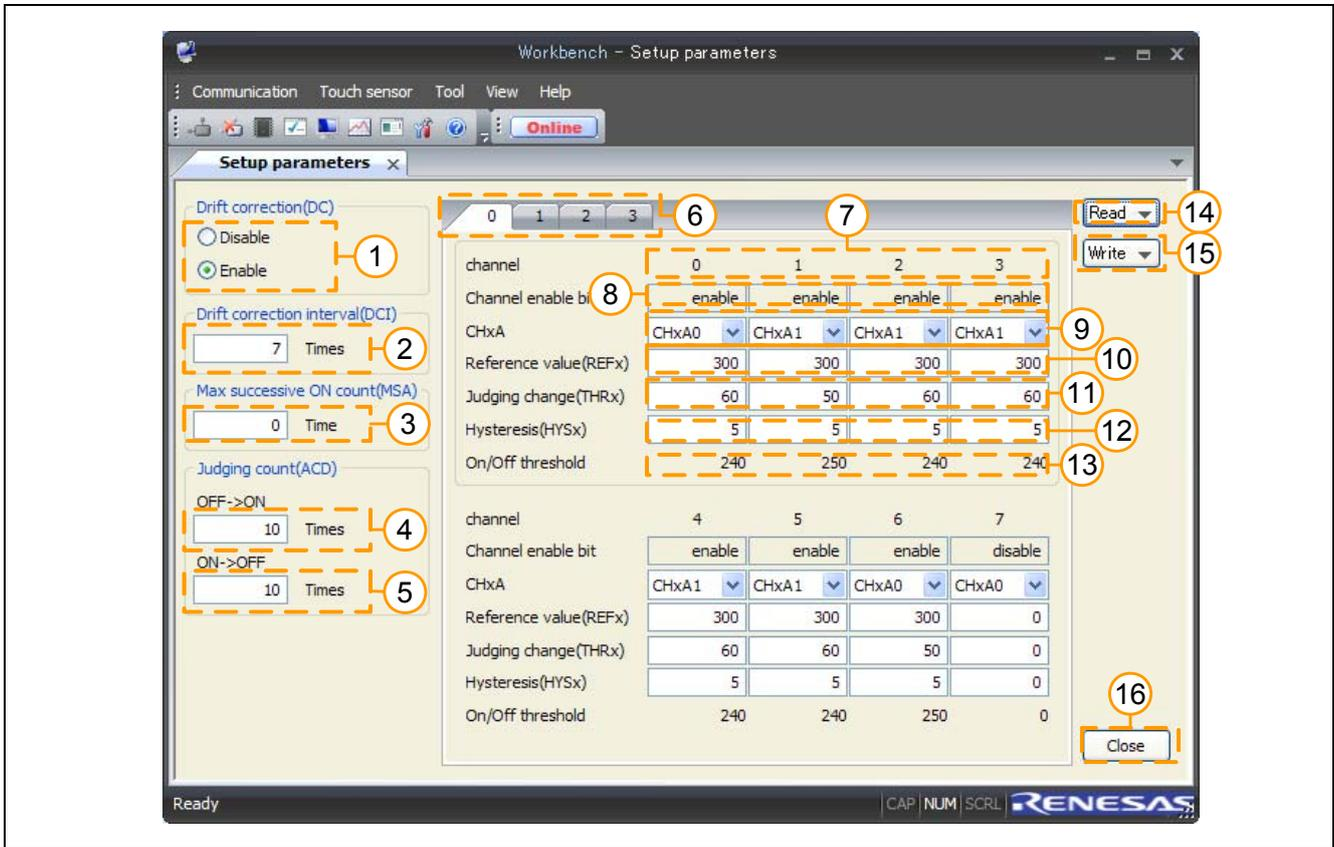
Figure 6-5 Setup parameters
