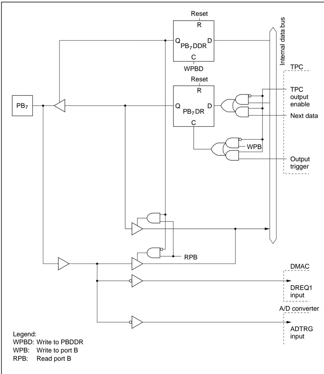
Figure C.11 (d) Port B Block Diagram (Pin PB7)
