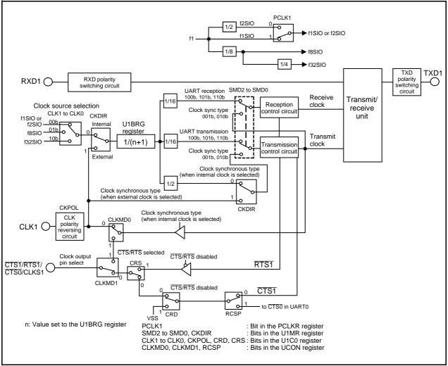
Figure 19.2 UART1 Block Diagram
