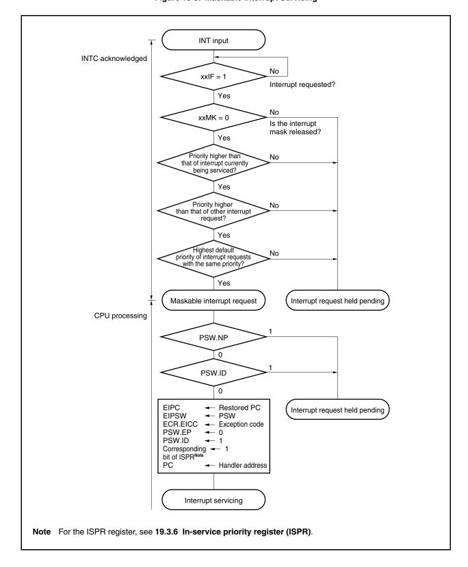
Figure 19-5. Maskable Interrupt Servicing
