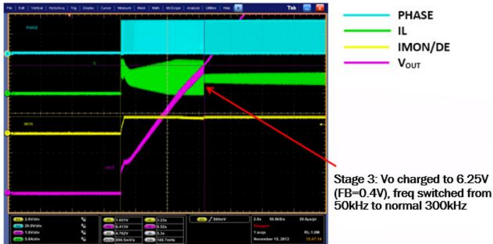
图字: 第三阶段: Vo 被充电到 6.25V (FB=0.4V), 频率从 50kHz 被切换至正常的 300kHz
