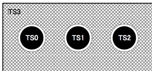
図 7 MEC+シールド電極構成例
