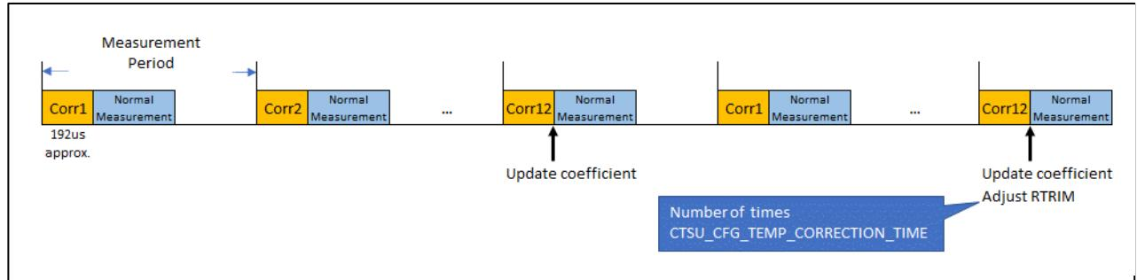
図 12 温度補正計測タイミングチャート
